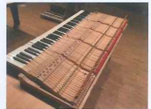
▲ハンマーを外したところ
